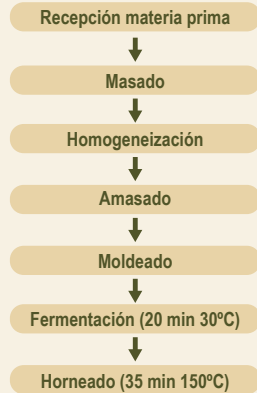
Figura 2. Diagrama de flujo para la producción de grisines
