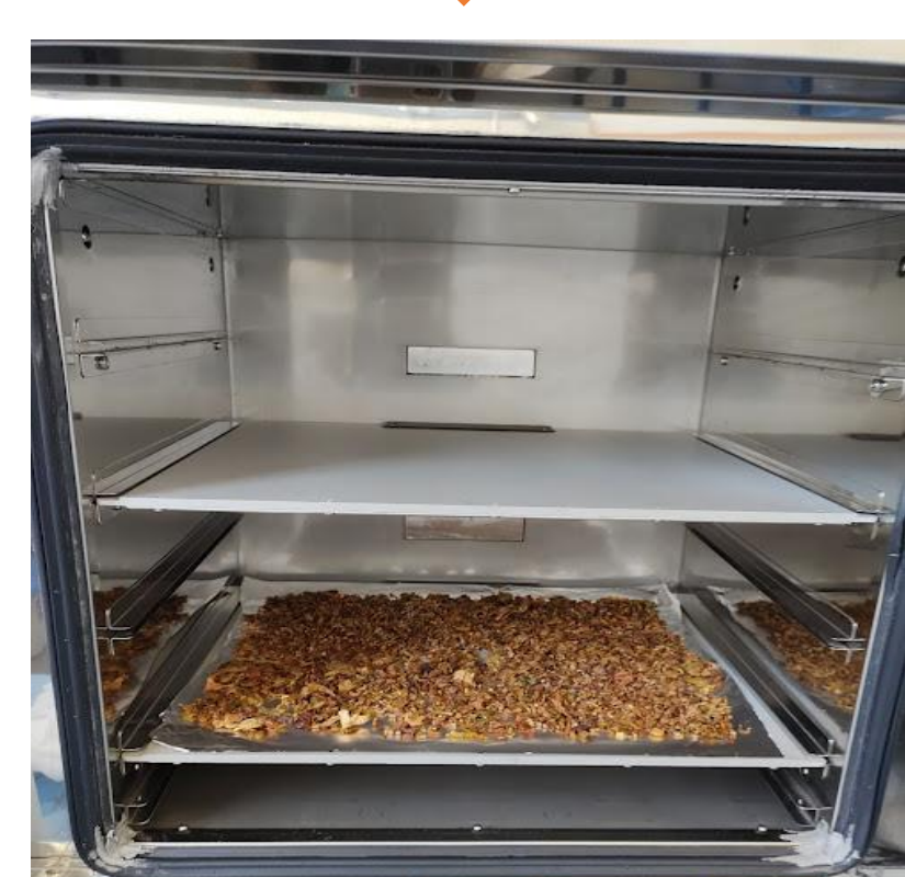
Estufa a vacío (Memmert, model VO 400/100 mbar)
